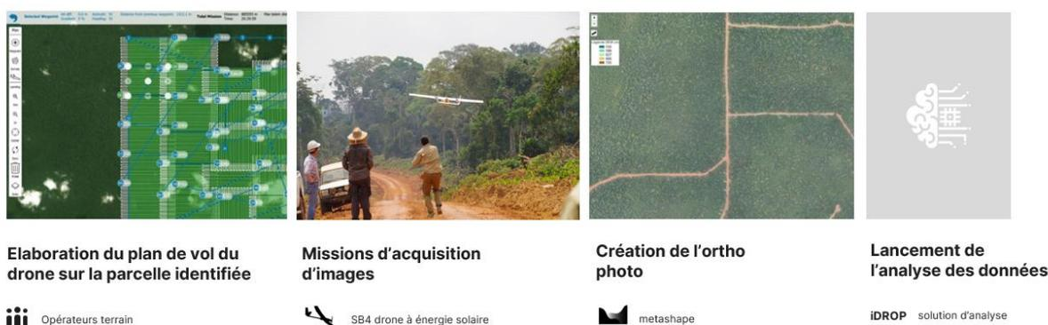
Composée de 4 étapes (Plan de vol, mission drone, Orthophoto, et reconnaissance automatique), la solution DeepForest devrait permettre à l'exploitant d'utiliser la technologie drone sans avoir à maîtriser lui-même. Une fois le processus déroulé, les données d'inventaires sont disponibles en ligne via un Dashboard proposant une carte positionnant toutes les essences recherchées.
