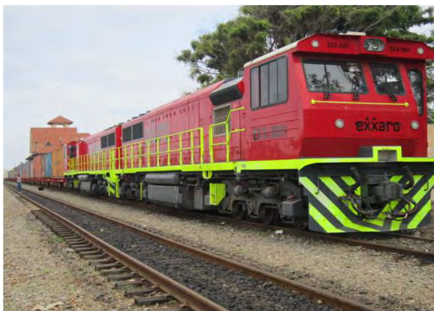
Figure 21 : 2013 : essai d'un train de 32 wagons-container tracté par 2 locomotives de 3.000cv (2.200 t)
