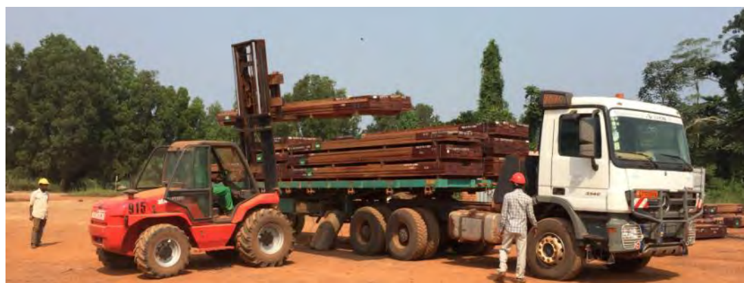
Figure 32 : Chargement de débités sur un camion-plateau à destination du port de Pointe Noire
