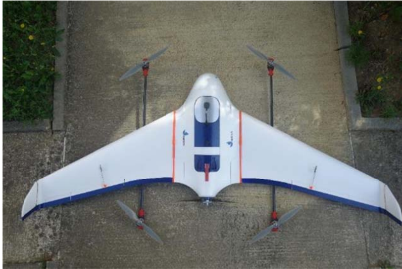
Figure 11 : Drone VTOL (Vertical Takeoff and landing) développé par Sunbirds.
