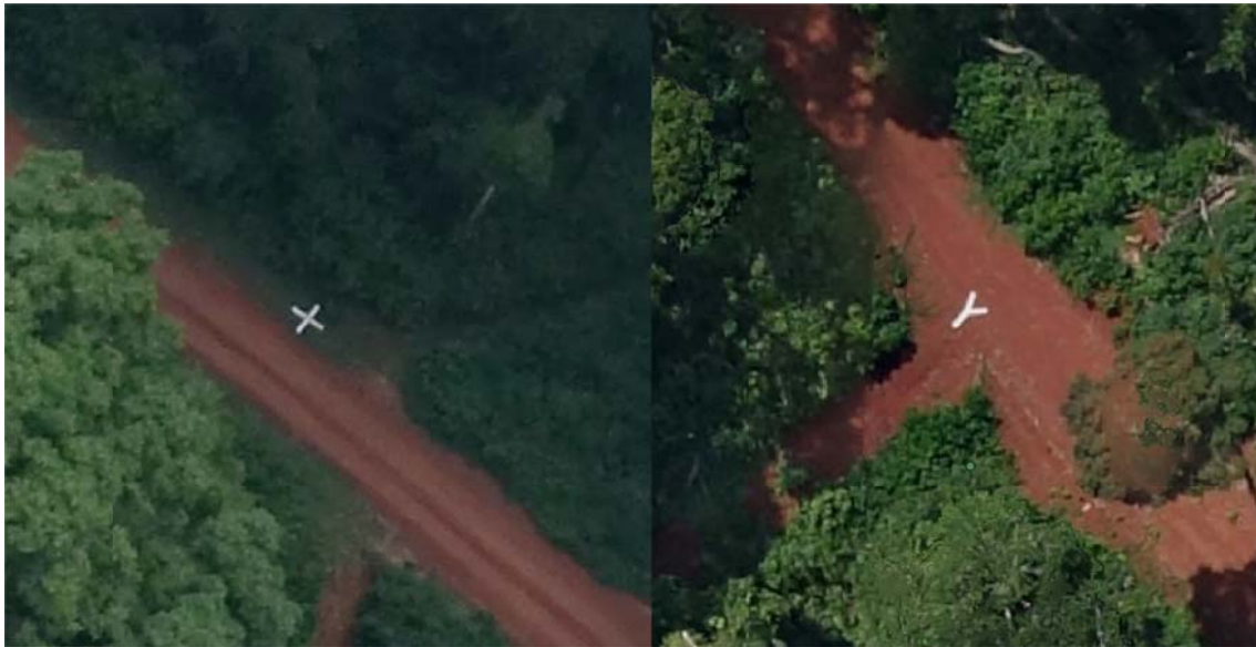
Figure 12 : Cibles pour les points de contrôle géographique (GCP).
