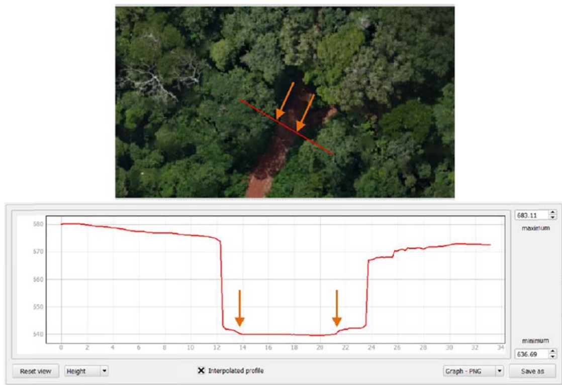
Figure 31 : Mesures de l’impact de la construction des routes sur la canopée, mesure des trouées
