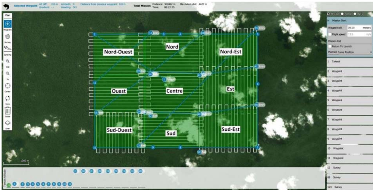
Figure 14 : Les 9 Plans de vol utilisés pour cartographier les 3000ha de l'assiette annuelle de coupe 2019 de chez IFO. Réalisé avec Belvedere (Sunbirds)
