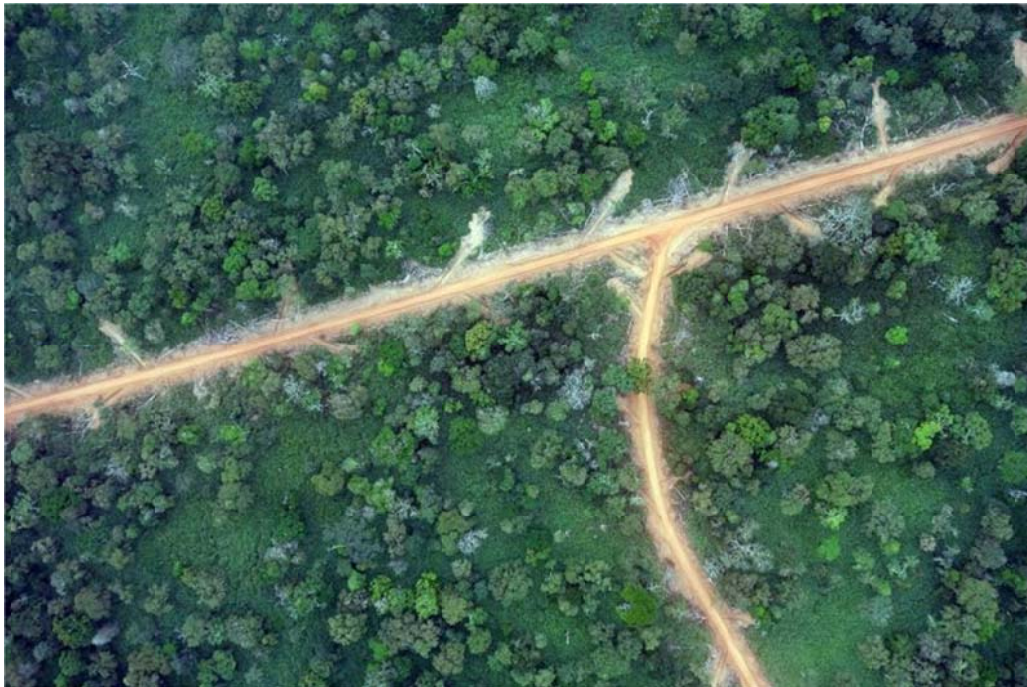
Figure 22 : Les photos aériennes géo-localisées permettent de mesurer la largeur des routes, des pistes de débardage ainsi que les trouées. Les surfaces exploitées peuvent être localisées et mesurées avec précision.
