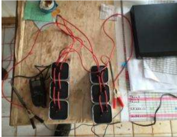
Figure 2 : Montage de l'alimentation électrique de la vidéosurveillance à l'atelier de Rougier. Figure 3 : Dispositif du système de vidéosurveillance au Baï de Dji-Dji.
