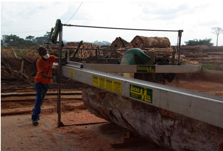
Photo 2 - Transformation à la scie mobile sur le site de Pallisco - CIFM
