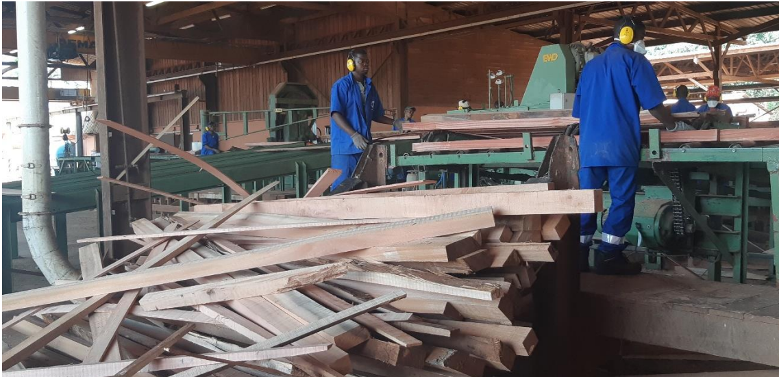
Photo 11 - Tri des bois lors de l'aboutage en scierie et production de « déchets massifs » (I)
