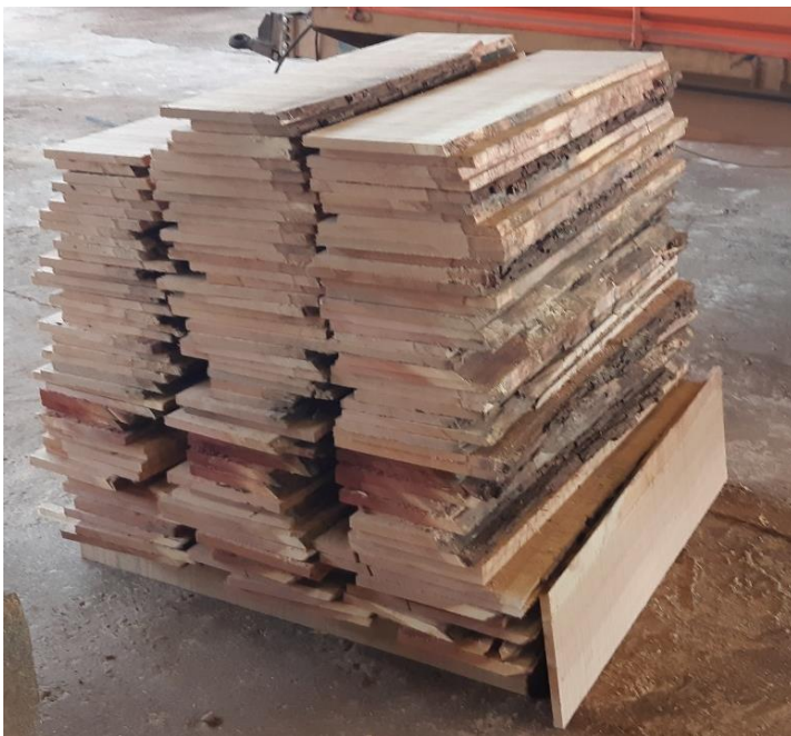
Photo 17 - Planches produites à partir de déchets pour recouvrir les cols de bois destinés à l'export
