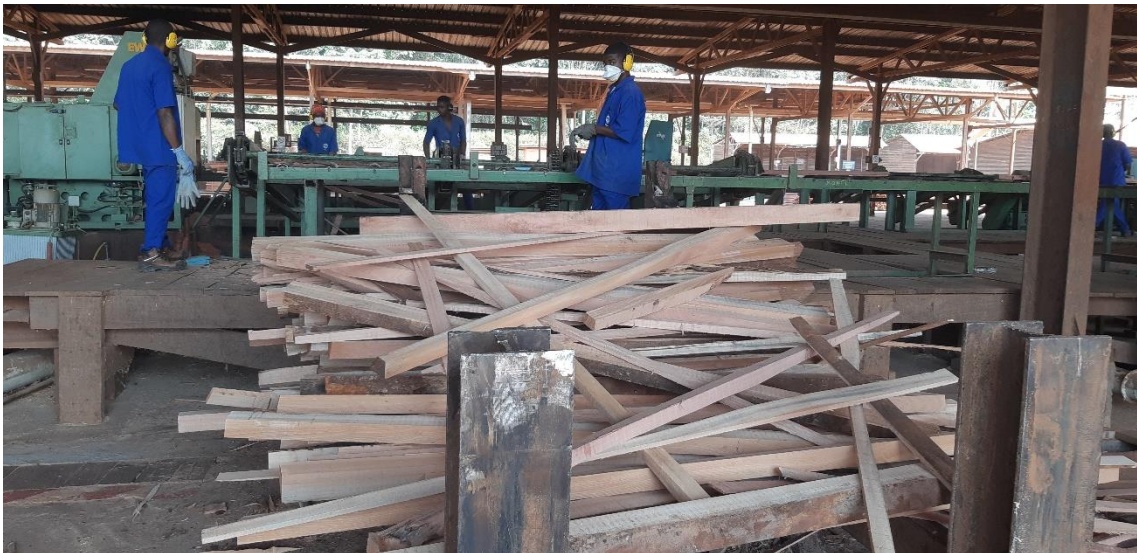
Photo 12 - Tri des bois lors de l'aboutage en scierie et production de « déchets massifs » (II)
