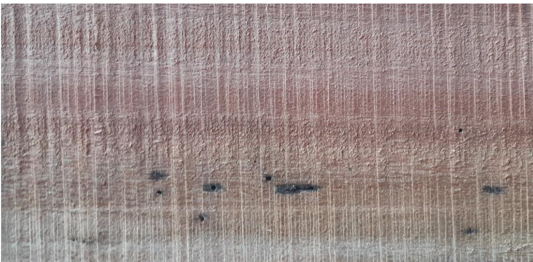
Photo 15 - Défaut rédhibitoire pour une production export : piqûres et traces d'aubier
