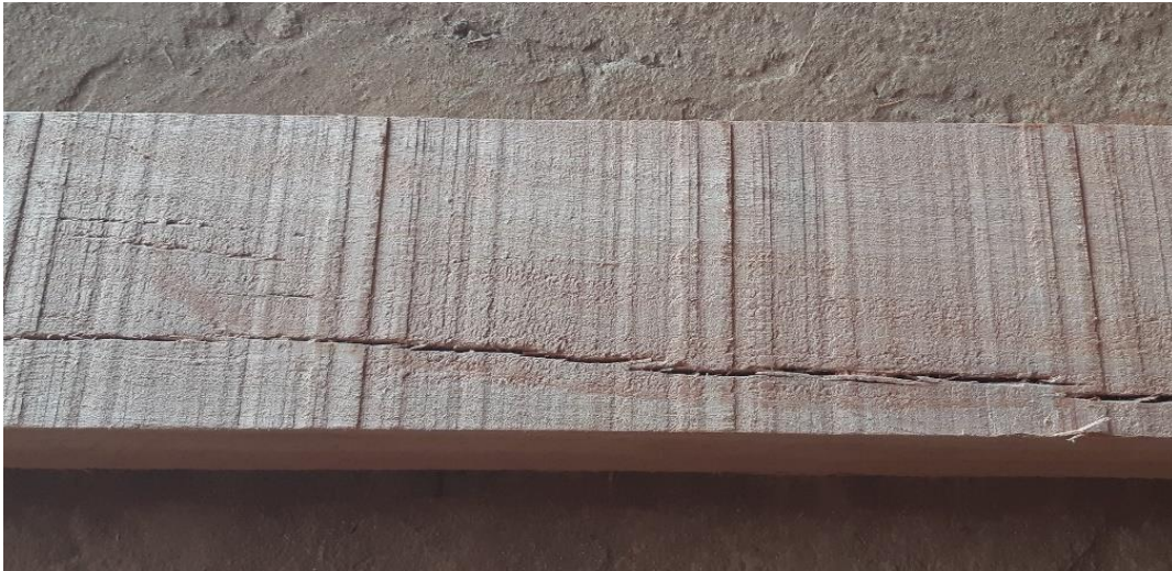
Photo 16 - Défaut rédhibitoire pour une production export : fentes
