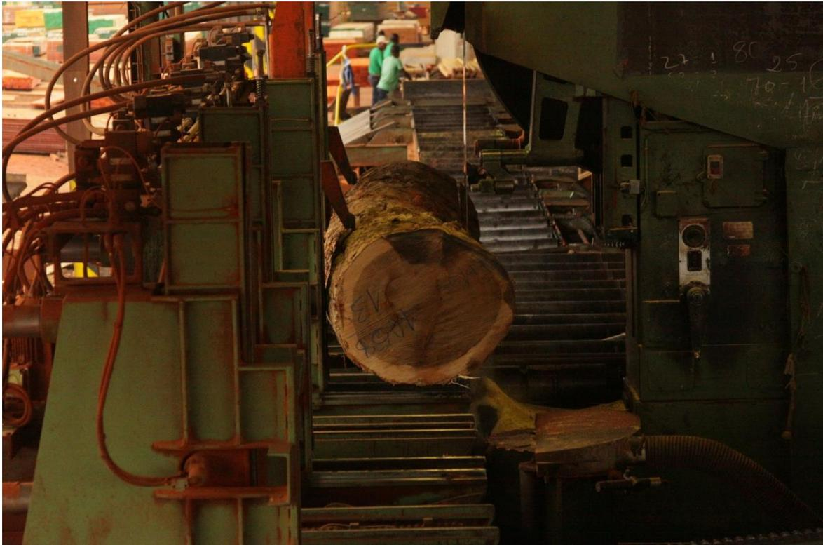
Figure 7 : Découpe d'un courçon de *Dialium lopense* avec la lame carbure
