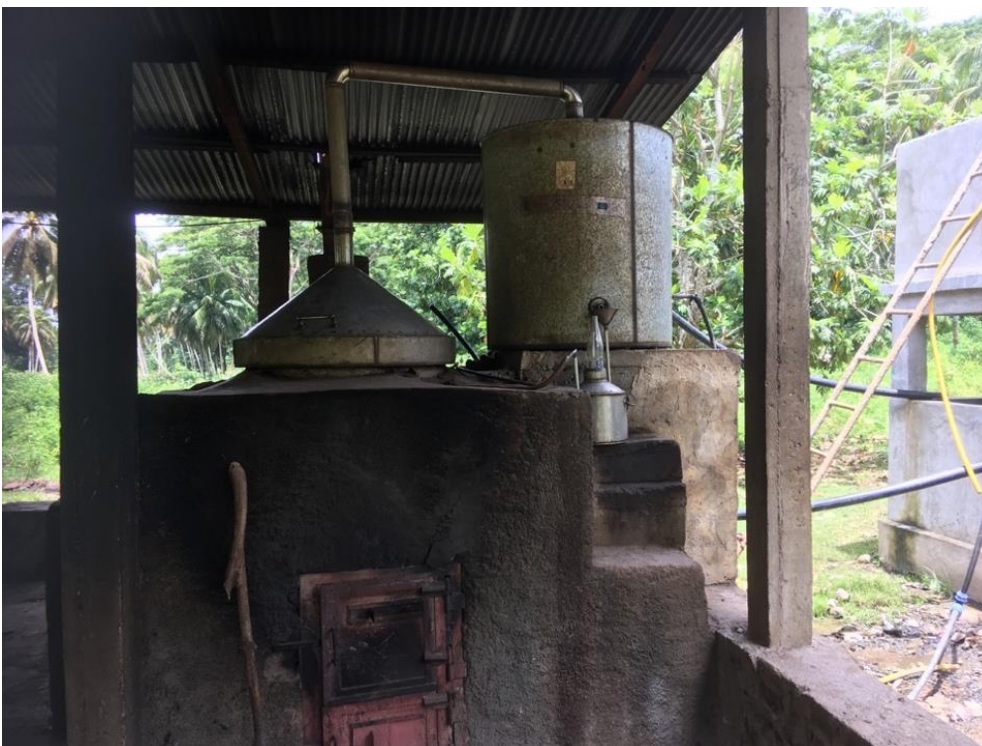
Unité de distillation aux Comores ©HH
