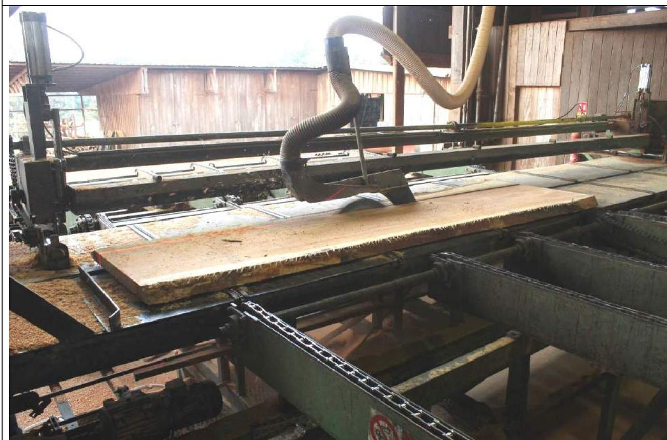
Délinage des plateaux en avivés avec guidage au laser
