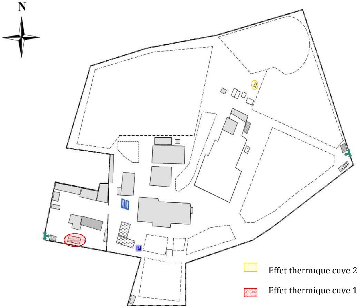
**Figure 14 :** Représentation des zones d'effet thermique des feux de nappe dans les cuves 1 et 2
